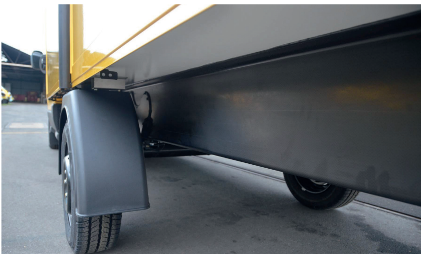
Bis zu 60% leichter als vergleichbare Stahlkonstruktionen sind die Chassis aus CFK-Bauteilen, die bei Carbon TT in Buxtehude gefertigt werden. Pultrusionstechnik von Pultrex ist die technische Basis der neuen Fertigung. ©Carbon TT
